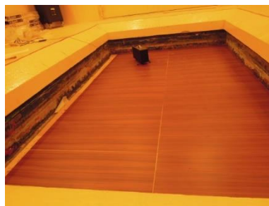
(b) 輕量衝擊源樓板衝擊音測試
